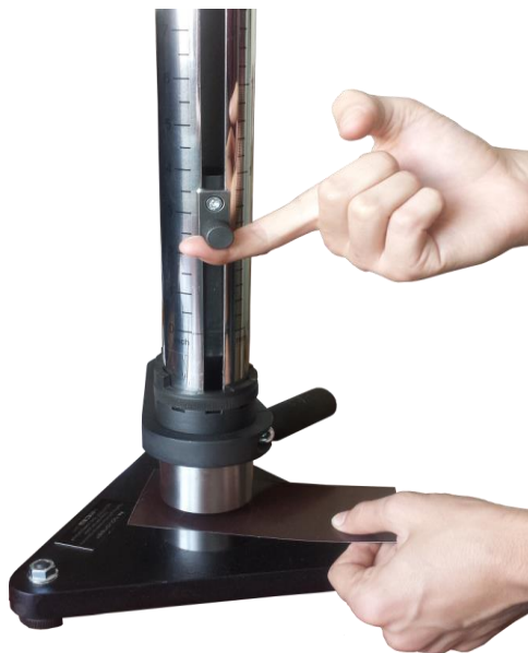
Рисунок 2.2. – Установка пластины для проведения испытания
