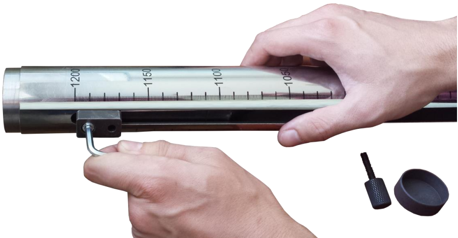
Рисунок 2.1 – Установка груза внутрь направляющей трубы
