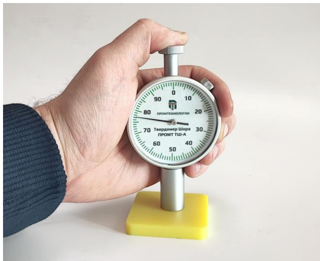
Рисунок 2.2 – Твердомер ПРМОТ ТШ-А во время проведения измерения
