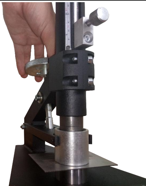
Рисунок 2.4 – Установка образца на наковальню
